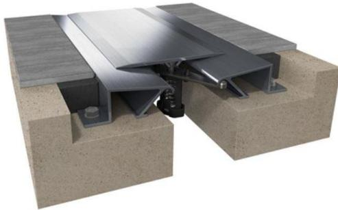
Sistema de cubrejunta a ras de piso diseñado para absorber movimientos sísmicos horizontales, verticales y de corte, apta para dilataciones desde 1" (25mm) y modificable para juntas de hasta 8" (200mm).
