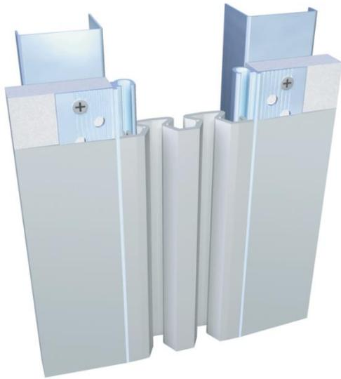
Cubrejunta de muro a ras interior-externo, diseñada para reducir la visibilidad de la unión. Sistema recomendado para dilataciones desde 2" (50mm) y modificable para juntas de hasta 6" (150mm).
