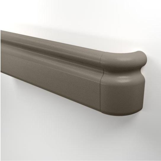
Línea de protección de muros Empter Guard, modelo EMP-1200 diseñado para la seguridad, apoyo manual de usuarios y protección de muros. Compuesto por un perfil de aluminio continuo firme pre ranurado de .080" (2mm) de grosor, aleación 6063 T5 y una cubierta de vinilo .080" (2mm). Con una altura 6 1/4" (159 mm) de altura x 1 1/2" (38 mm) de diámetro de agarre y fabricados en largos estándar de 3.66m.
