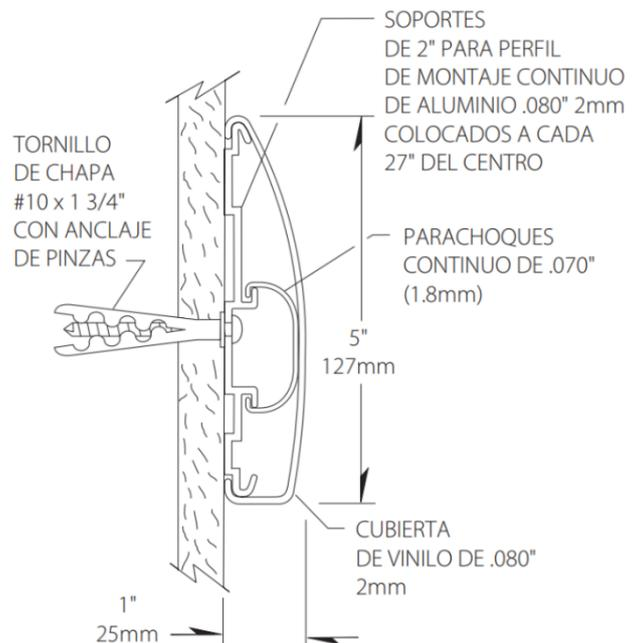
Para su instalación, los muros deben estar aplomados y reforzados; en el caso de tabiques debe ser instalado un perfil de madera de mínimo 3 cm de espesor. Si el largo es de más de 12' (3.66 m), se recomienda utilizar un empalme de aluminio detrás de los topes de vinilo para dar más apoyo.
