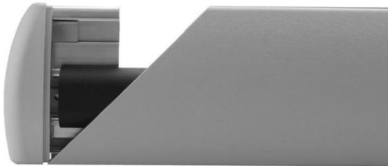
Línea de protección de muros Empter Guard, modelo EMP-1500i diseñado para la protección de muros. Compuesto por clips de aluminio de .080" (2mm) de grosor y aleación 6063-T5, un parachoques interno de .080" (2mm) y una cubierta de vinilo .080" (2mm), y fabricados en largos estándar de 3.66m.
