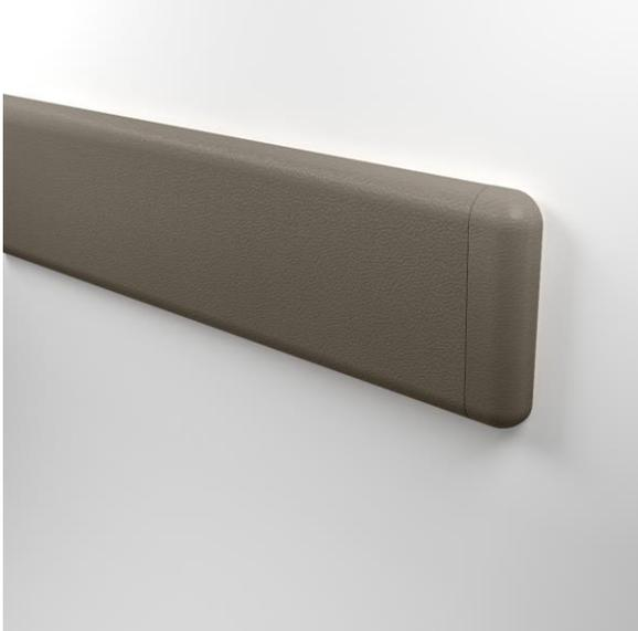
Línea de protección de muros Empter Guard, modelo EMP-1600 diseñado para la protección de muros. Compuesto por un perfil de aluminio continuo firme pre ranurado de .080" (2mm) de grosor y aleación 6063-T5, un parachoques interno de .080" (2mm) y una cubierta de vinilo .080" (2mm), y fabricados en largos estándar de 3.66m.
