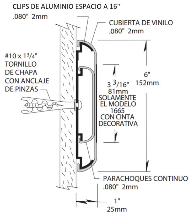
Para su instalación, los muros deben estar aplomados y reforzados; en el caso de tabiques debe ser instalado un perfil de madera de mínimo 3 cm de espesor. Si el largo es de más de 12' (3.66 m), se recomienda utilizar un empalme de aluminio detrás de los toques de vinilo para dar más apoyo.
