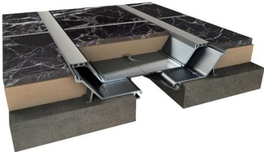
Sistema de cubrejunta a ras de piso con uniones reducidas que minimizan la interrupción visual de los acabados de pisos. Diseñado para movimientos sísmicos y térmicos, con sistema pop up incorporado. Recomendado para pisos interiores y exteriores, apto para dilataciones desde 2" (50mm) y modificable para juntas de hasta 32" (800mm).
