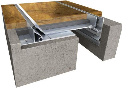
Sistema de cubrejunta a ras de piso con uniones reducidas que minimizan la interrupción visual de los acabados de pisos. Diseñado para movimientos sísmicos y térmicos, con sistema pop up incorporado. Recomendado para pisos interiores y exteriores, apto para dilataciones desde 2" (50mm) y modificable para juntas de hasta 32" (800mm).
