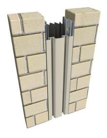
Cubrejunta de muro a ras exterior, diseñada para reducir la visibilidad de la unión, incluye una membrana de barrera de humedad EPDM flexible integral, reforzada de 45 mil de grosor con refuerzo de nylon. Sistema recomendado para dilataciones desde 2" (50mm) y modificable para juntas de hasta 6" (150mm).
