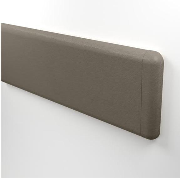
Línea de protección de muros Empter Guard, modelo EMP-700 diseñado para la protección de muros. Compuesto por un perfil de aluminio continuo firme pre ranurado de .080" (2mm) de grosor y aleación 6063 T5, un parachoques interno de .080" (2mm) y una cubierta de vinilo .080", y fabricados en largos estándar de 3.66m.
