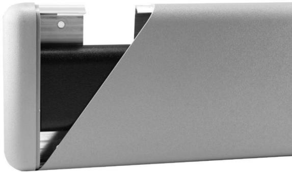
Línea de protección de muros Empter Guard, modelo EMP-700i diseñado para la protección de muros. Compuesto por clips de aluminio de .080" (2mm) de grosor y aleación 6063-T5, un parachoques interno de .080" (2mm) y una cubierta de vinilo .080" (2mm), y fabricados en largos estándar de 3.66m.
