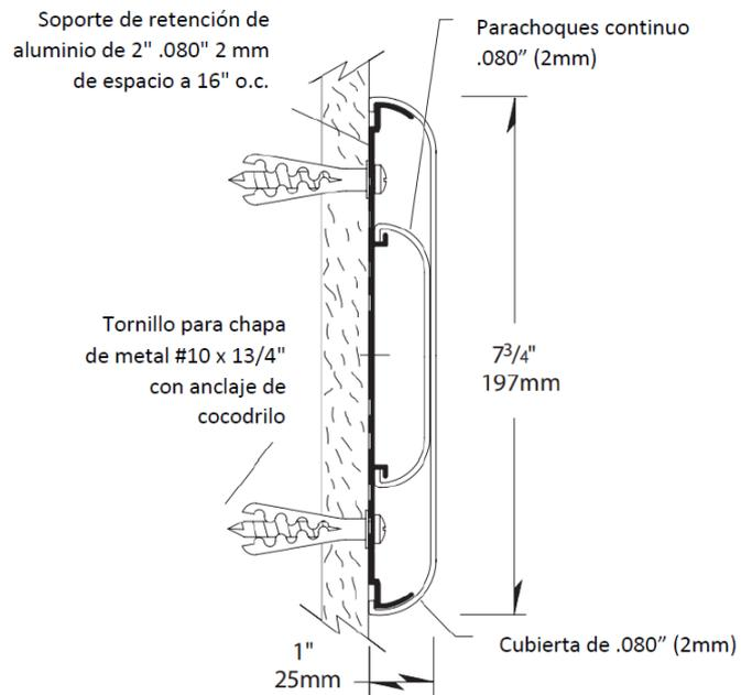
Para su instalación, los muros deben estar aplomados y reforzados; en el caso de tabiques debe ser instalado un perfil de madera de mínimo 3 cm de espesor. Si el largo es de más de 12' (3.66 m), se recomienda utilizar un empalme de aluminio detrás de los toques de vinilo para dar más apoyo.
