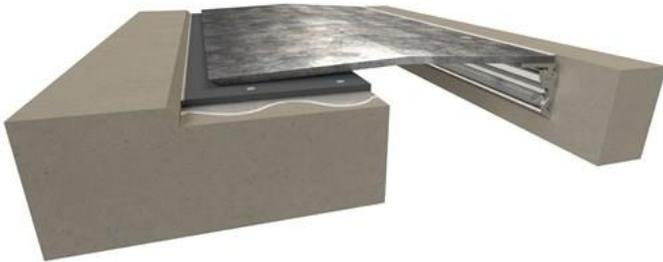
Sistema de cubrejunta diseñado para exteriores, capaz de soportar el tráfico vehicular y +/- 100% de movimiento de corte lateral. Incorpora un exclusivo perfil coronado está diseñado para una mayor resistencia a la carga y un ciclo de vida más prolongado. Disponible para dilataciones desde 4" (100mm) y modificable para juntas de hasta 24" (600mm).
