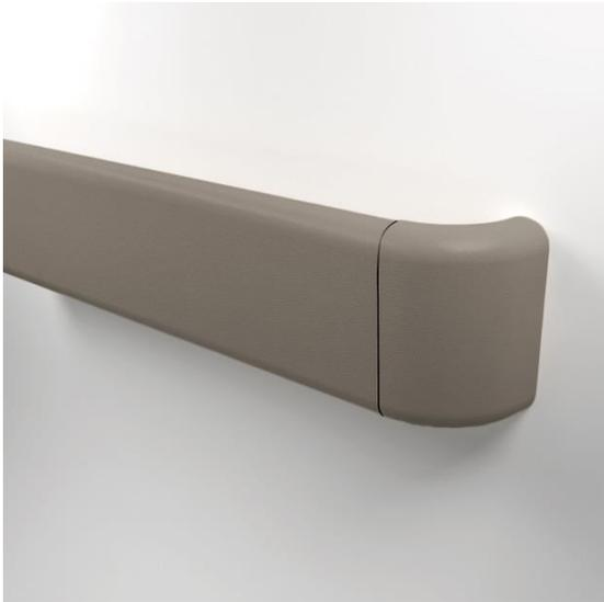
Línea de protección para muros Empter Guard, modelo EMP-800 diseñado para la seguridad, apoyo manual de usuarios y protección de muros. Compuesto por un perfil de aluminio continuo firme pre ranurado de .080" (2mm) de grosor, aleación 6063 T5 y una cubierta de vinilo rígido de 2mm de espesor, con una altura de 140mm y diámetro de agarre de 38mm, y fabricados en largos estándar de 3.66m.
