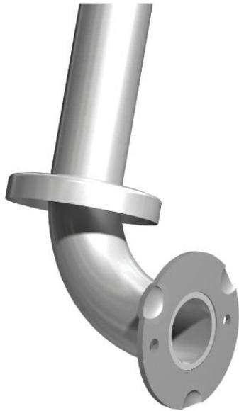
Barra de seguridad fabricada bajo normas de Estados Unidos de la línea Empter Bath. Cuenta con 1-1/4" de diámetro [Ø32] con cubiertas de brida a presión para montaje oculto debe ser de aleación de acero inoxidable 304 18-8. La tubería tiene un diámetro de 1-1/4" (Ø32) x calibre 18. La cubierta a presión es de calibre 22 (0.03").
