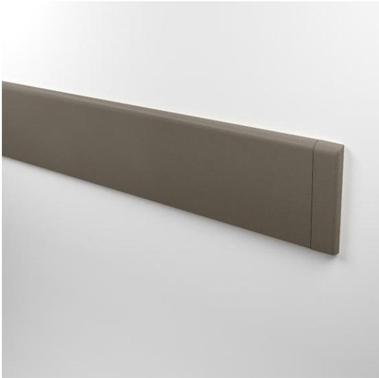
Línea de protección de muros Empter Guard, modelo EMP-WB4 diseñado para la protección de muros. Compuesto por un perfil de aluminio continuo firme pre ranurado de .060" (1.5mm) de grosor y aleación 6063-T5, y una cubierta de vinilo .080" (2mm), y fabricados en largos estándar de 2.44m.
