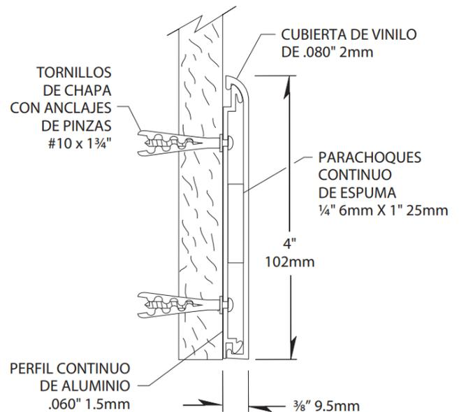
Para su instalación, los muros deben estar aplomados y reforzados; en el caso de tabiques debe ser instalado un perfil de madera de mínimo 1 cm de espesor.
